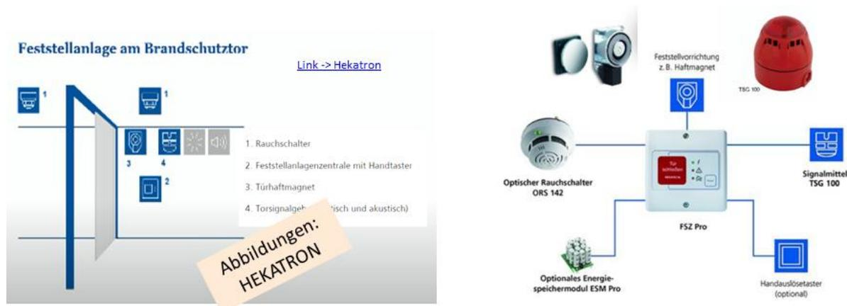
Abbildung 14. Komponenten einer Feststellanlage (FStA): [Video](#)
