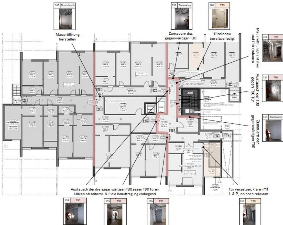
Abbildung 5: Erneuerung von Türen / Abschlüssen / Durchbrüchen in den Untergeschossen
